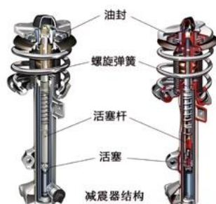
减震器结构图
